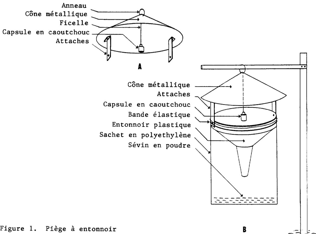
Figure 1. Piège à entonnoir
