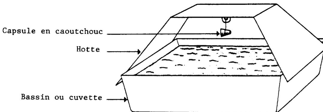
Figure 2. Piège à eau
